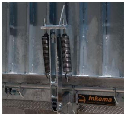
Su sistema de resortes permite soportar hasta 4Tn.
