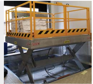
Mesa galvanizada con puertas batientes, barandillas laterales y cierre interlock.
