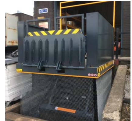
Mesa con puertas batientes, barandillas, labio hidráulico y cota de malla.
